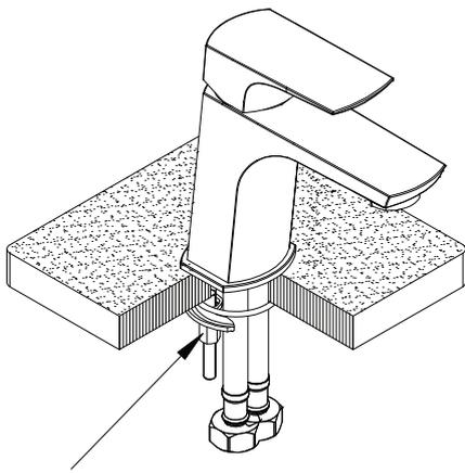
5. Stellen Sie sicher, dass die Schraubmutter fest ist und die Armatur stabil ist
