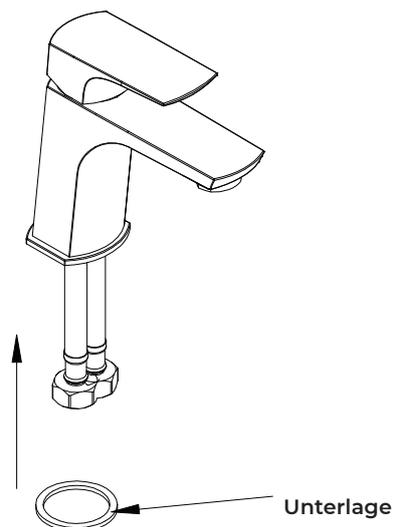
**2.** Installieren Sie die Unterlage unter dem Körper der Armatur
