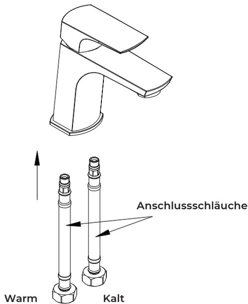
**1.** Schrauben Sie flexible Schläuche an den Körper der Armatur
