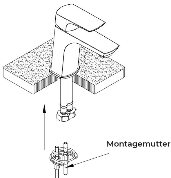
**4.** Setzen Sie die Befestigungsmutter unter den Körper der Armatur und befestigen Sie sie
