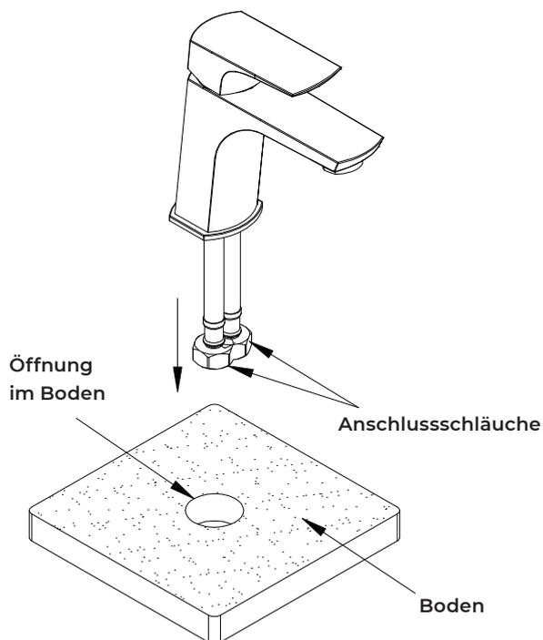
**3.** Stecken Sie die Anschlusschläuche in die Öffnung im Boden (z. B. bei einem Waschbecken, bei einem Bidet).
